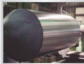
連續退火線輥輪(Cr 3 C 2 Cermet) Hearth Roll for CAL or CAPL
