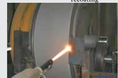
大型PISTON噴焊施工現況 PISTON (Big form) Coating Processing
