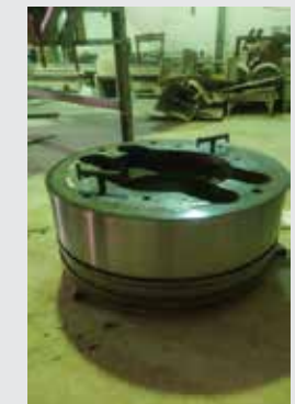
大型PISTON噴焊再生 PISTON (big form) recoating
