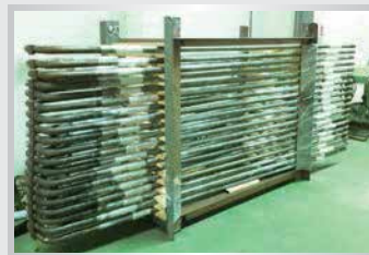
CDQ設備爐管 (Ống lò hơi CDQ)
