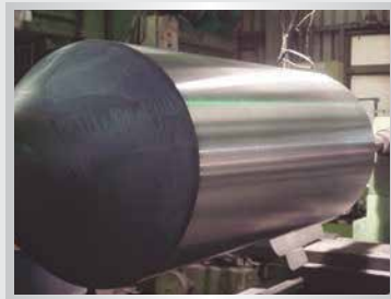
連續退火線輥輪(Cr 3 C 2 Cermet) Trục lò (Cr 3 C 2 Cermet)
