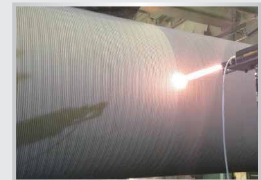
複捲輾施工 (Phun trên trục Tua)
