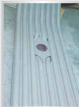
吹灰口管排 (Đường ống dẫn khí)
